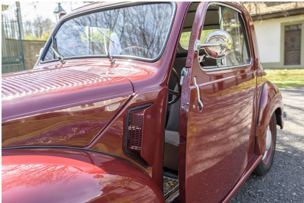
Die Türen des Topolino werden vorne geöffnet und nicht hinten. Links von der geöffneten Türe ist eines der offenen Flügelchen zu sehen, welches als eine Art Klimaanlage dient.
